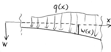
Verlauf der neutralen Faser eines gebogenen Balkens ("Biegelinie") berechnet sich entweder aus der Gleichung
