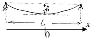
Form eines Brückenseils zu  $y = \frac{4hx^2}{L^2}$  berechnet. Sie hängt nicht von der Größe der Streckenlast  $q_0$  ab! Bei einer beliebigen homogenen Änderung der Streckenlast ( $q_0 = konst$ ) behält das Seil die gleiche Form und bleibt momentenfrei. Das gilt auch für *negative*  $q_0$ .
