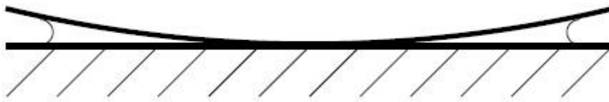
Abb. 1: Kontakt einer Kapillarbrücke mit einer harten Kugel.
