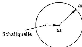
Für  $t \rightarrow \infty$  wird die Schallwelle den gesamten Raum erreichen. Ist  $u > c$ , so ergibt sich die im nächsten Bild skizzierte Lage der Schallwelle. Für  $t \rightarrow \infty$  wird die Schallwelle nicht den gesamten Raum erreichen.
