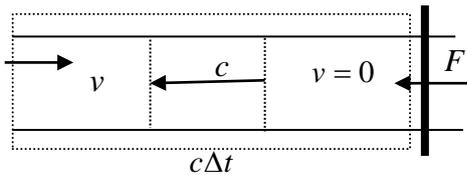
Die Änderung des Impulses des Kontrollvolumens ist  $\Delta P = 0 - \rho A c \Delta t v$ . Nach dem Impulssatz gilt  $\Delta P / \Delta t = -\rho v c A = -F$ . Der Druck ist demnach
