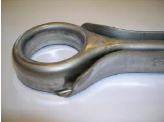
Querlenker mit Blechdurchzug (unbeschichtet)
