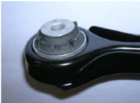
Querlenker mit Blechdurchzug (unbeschichtet)
