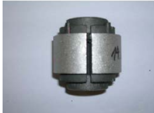
Einseitig geschlitztes Gummi-Metall-Lager mit gestrahlter AlMg3-Oberfläche
