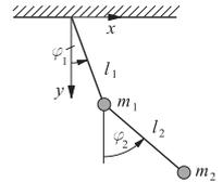
(a) Bestimme für die Bewegung des skizzierten Doppelpendels in einer vertikalen Ebene (Erdbeschleunigung  $g$ ) mit Hilfe der LAGRANGESchen Gleichungen 2. Art die Bewegungsgleichungen. Nutze die generalisierten Koordinaten  $\varphi_1$  und  $\varphi_2$ .
