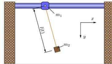
Die Aufhängevorrichtung eines ebenen Pendels mit der zeitlich veränderlichen Länge  $l(t)$  und der Pendelmasse  $m_2$  gleitet reibungsfrei auf einer horizontalen Führung und hat die Masse  $m_1$ .
