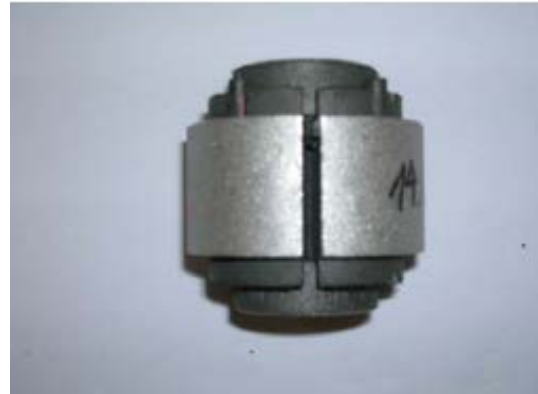
Einseitig geschlitztes Gummi-Metall-Lager mit gestrahlter AlMg3-Oberfläche
