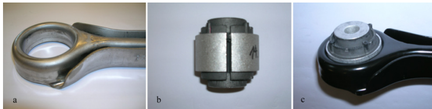
Abb. 1(a) Querlenker mit Blechdurchzug, (b) Einseitig geschlitztes Gummi-Metall-Lager, (c) Fertiger Querlenker mit eingepresstem Lager.
