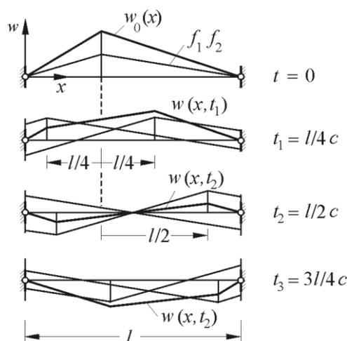
Die Saite schwingt mit einer Schwingungsdauer  $T = \frac{2l}{c}$ .
