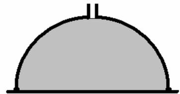
4. Der Abfluß eines Wasserbehälters (Füllhöhe  $h$ ) ist durch eine Halbkugelschale (Gewicht  $G$ , Radius  $r_0$ ) abgeschlossen. Welche Kraft  $F$  ist notwendig, um den Abfluß zu öffnen?
