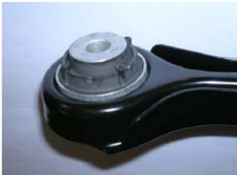
Querlenker mit Blechdurchzug (unbeschichtet)
