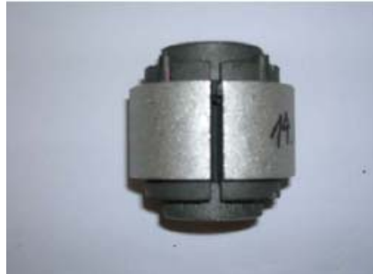
Einseitig geschlitztes Gummi-Metall-Lager mit gestrahlter AlMg3-Oberfläche
