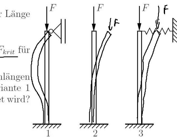
(a) Berechnen Sie die kritischen Lasten  $F_{krit}$  für die Varianten 1 bis 3!
